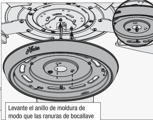
Levante el anillo de moldura de modo que las ranuras de bocallave se deslicen sobre los tornillos. Asegúrese de que el conector del enchufe sea empujado a través del orificio central del anillo de moldura.
