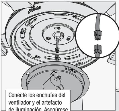
Conecte los enchufes del ventilador y el artefacto de iluminación. Asegúrese de alinear las marcas de color de los conectores.
