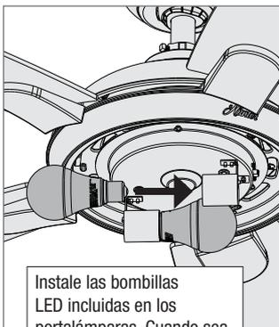
Instale las bombillas LED incluidas en los portalámparas. Cuando sea necesario, reemplace las bombillas con unas de la misma potencia.
