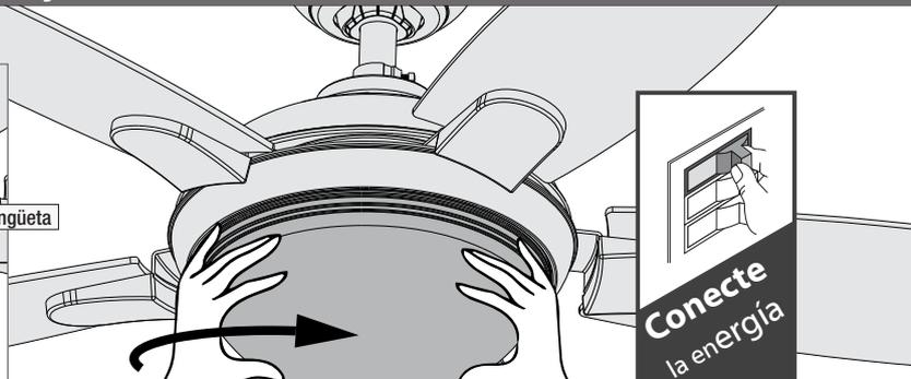
Para sujetar la pantalla de vidrio, levántela y hágala girar hacia la derecha un cuarto de vuelta completa de la pantalla hasta que se detenga.
