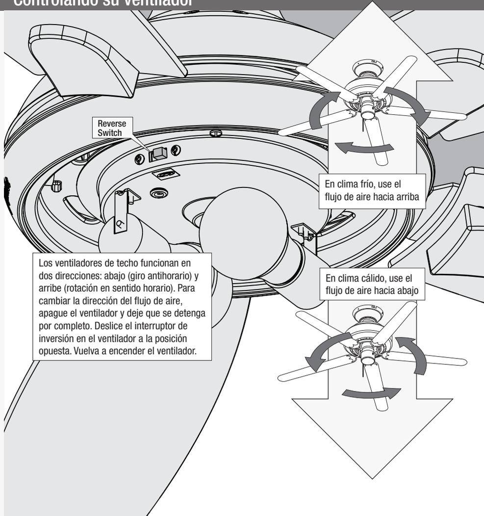
Los ventiladores de techo funcionan en dos direcciones: abajo (giro antihorario) y arriba (rotación en sentido horario). Para cambiar la dirección del flujo de aire, apague el ventilador y deje que se detenga por completo. Deslice el interruptor de inversión en el ventilador a la posición opuesta. Vuelva a encender el ventilador.
