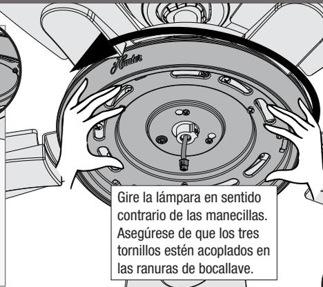
Gire la lámpara en sentido contrario de las manecillas. Asegúrese de que los tres tornillos estén acoplados en las ranuras de bocallave.
