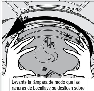
Levante la lámpara de modo que las ranuras de bocallave se deslicen sobre los tornillos. Gire la lámpara en sentido contrario de las manecillas. Asegúrese de que los tres tornillos estén acoplados en las ranuras de bocallave.
