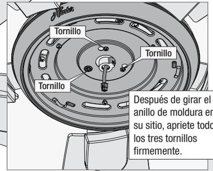
Después de girar el anillo de moldura en su sitio, apriete todos los tres tornillos firmemente.
