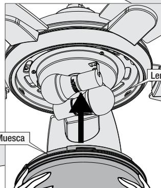
Levante la pantalla y alinee las muescas en la pantalla de vidrio con las lengüetas en el conjunto de luz.
