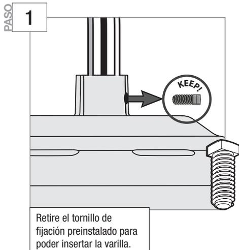
Retire el tornillo de fijación preinstalado para poder insertar la varilla.
