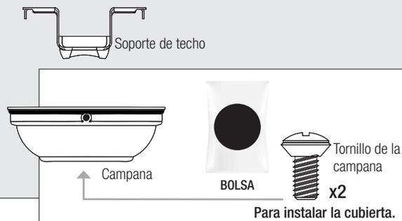
Para instalar la cubierta.
