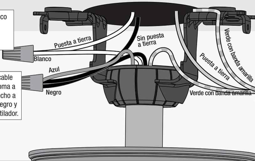
Conecte los tres cables de toma de tierra (verde, con raya verdes/amarilla, o de cobre desnudo) procedente del techo, de la varilla hueca y del soporte para montaje.
