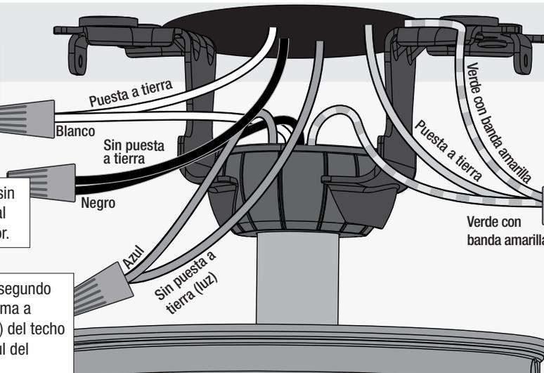
Conecte los tres cables de toma de tierra (verde, con raya verdes/amarilla, o de cobre desnudo) procedente del techo, de la varilla hueca y del soporte para montaje.
