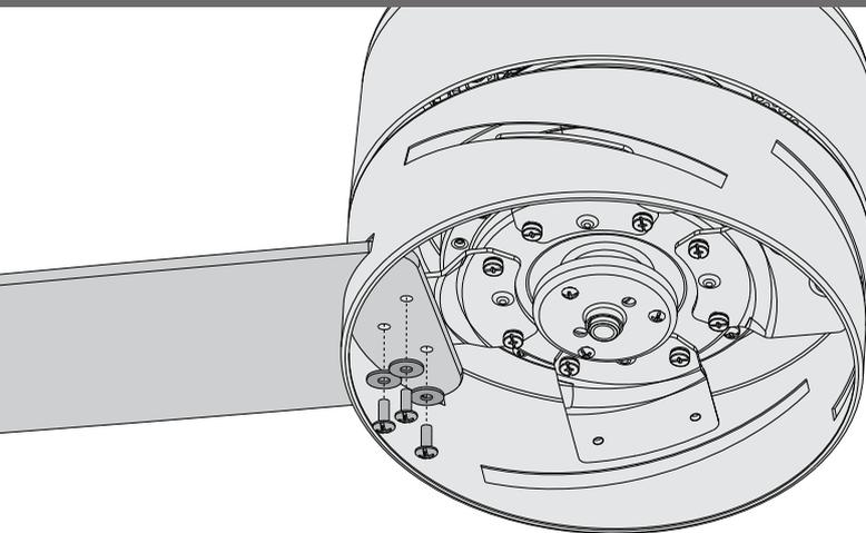
Coloque las arandelas de paleta incluidas en la bolsa de materiales ■ en los tornillos de paleta incluidos en la bolsa de materiales ▲. A continuación instale los tornillos de paleta para fijar ambas paletas al soporte de paleta.
