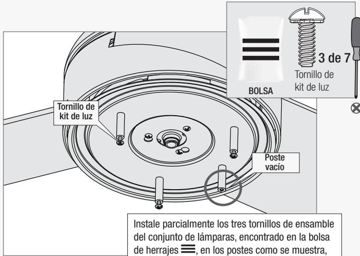
Instale parcialmente los tres tornillos de ensamble del conjunto de lámparas, encontrado en la bolsa de herrajes ≡, en los postes como se muestra, dejando vacío el poste marcado con un círculo.
