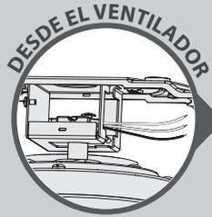
Usando un conector de alambre anaranjado de la bolsa de materiales ★, conecte los 3 alambres de puesta a tierra (verde, verde con banda amarilla, y cobre desnudo) del ventilador, el techo, y el soporte de suspensión.
