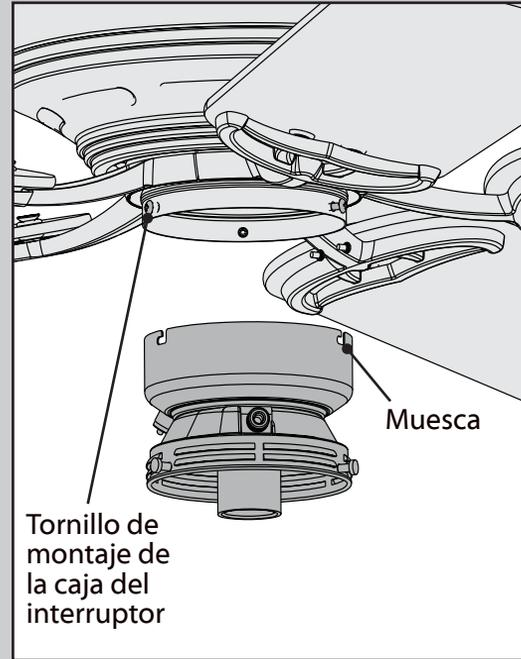
Alinee las muescas en los lados de la caja inferior del interruptor con los tornillos en la caja superior del interruptor. Gire la caja inferior del interruptor en sentido horario para asegurar los tornillos en su lugar.
