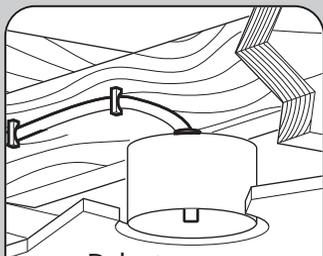
Debe tener la capacidad de asegurar el ventilador a la estructura de la edificación o caja de salida aprobada para ventiladores
