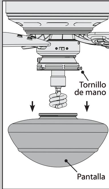
**Para cambiar la bombilla,** desenrosque los tornillos de mano mientras sostiene la pantalla con la otra mano. Quite cuidadosamente la pantalla. Desenrosque la bombilla y reemplácela por bombilla del mismo tipo y voltaje. Reinstale el conjunto de pantalla.
