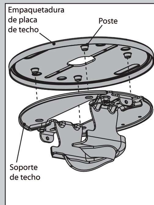
Instale la junta de placa de techo en la placa de techo. Los cuatro orificios en la placa de techo deberían alinearse con los cuatro postes en la junta.
