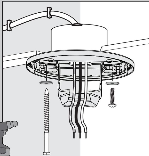
**Use tornillo para madera de 3"** (incluido) para asegurar a la estructura de soporte con la caja de salida eléctrica aprobada. Taladre agujeros piloto de 9/64" en la estructura de soporte para ayudar a asegurar el soporte de techo con los materiales de la bolsa ★
