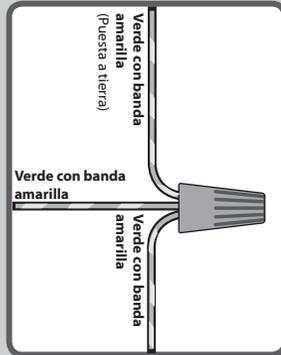
Usando un conector de alambre anaranjado de la bolsa de materiales ★, conecte los 3 alambres de puesta a tierra (verde, verde con banda amarilla, y cobre desnudo) del ventilador, la varilla y el soporte de suspensión.
