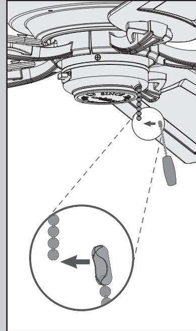
Coloque el pendiente de cadena en la cadena corta que sale de la caja del interruptor.
