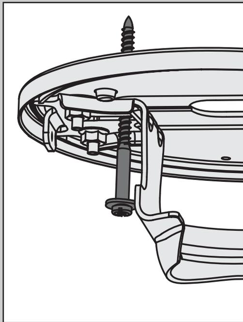
Atraviese la junta de caucho con el tornillo para madera con el objeto de instalar el conjunto de soporte de techo en la estructura de soporte o en la caja de salida aprobada para ventiladores de techo.
