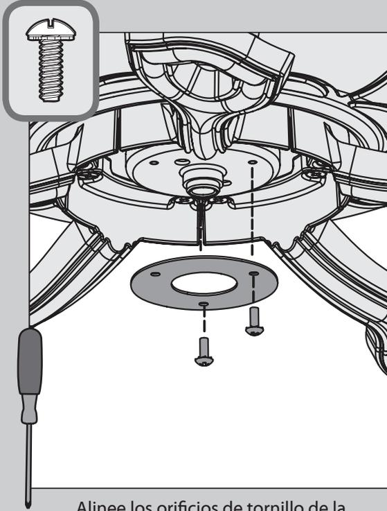
⊗ Alinee los orificios de tornillo de la empaquetadura de la caja del interruptor. Atornille a medias dos tornillos de montaje de la caja que están en la bolsa de materiales ≡ al alojamiento del motor. No importa cuáles agujeros escoja.
