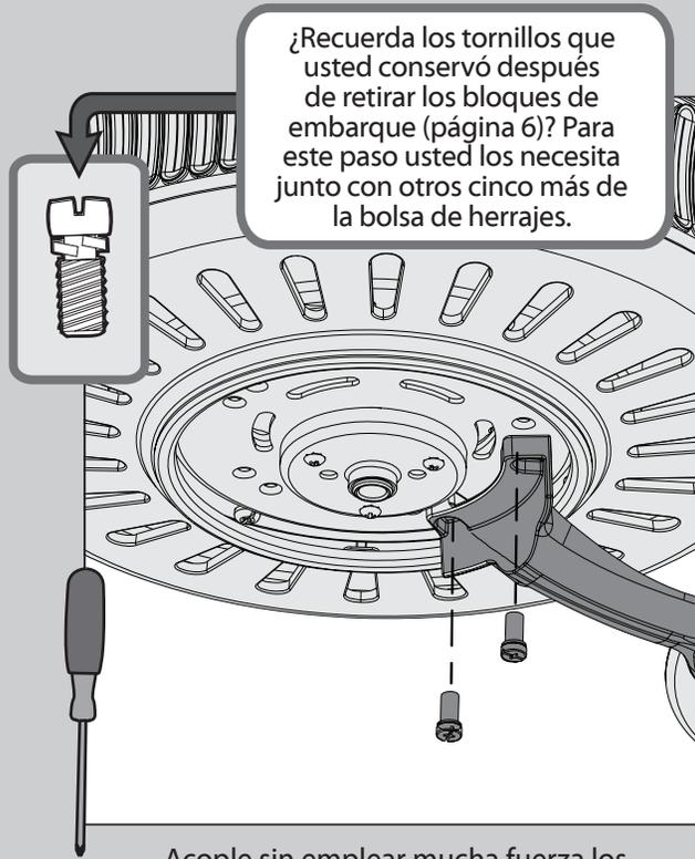
¿Recuerda los tornillos que usted conservó después de retirar los bloques de embarque (página 6)? Para este paso usted los necesita junto con otros cinco más de la bolsa de herrajes.
