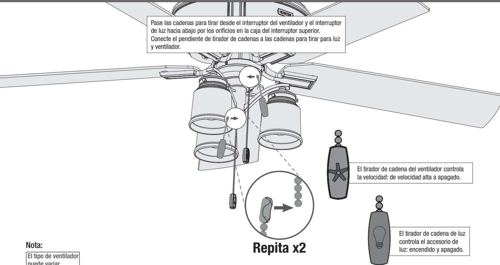
El tirador de cadena del ventilador controla la velocidad: de velocidad alta a apagado.
