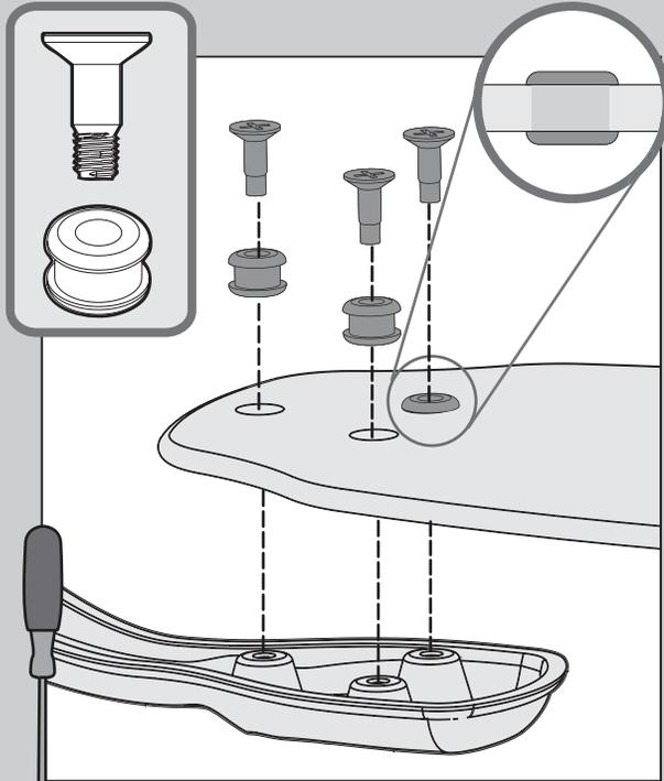
⊗ Inserte las arandelas de la bolsa de materiales ■ en los agujeros de las paletas, luego asegure cada paleta a un soporte de paleta con los tornillos de la bolsa de materiales ▲.
