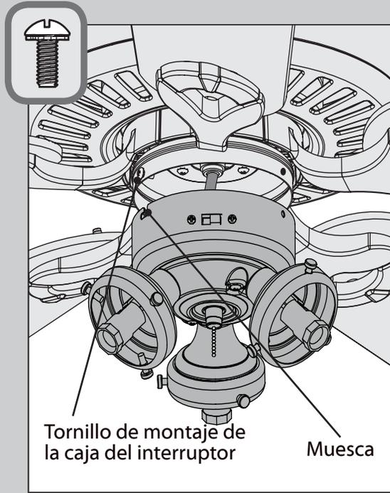
Instale parcialmente dos de los tornillos de las cajas del interruptor que están en la bolsa. Alinee las muescas en los lados de la caja inferior del interruptor con los tornillos en la caja superior del interruptor. Gire la caja inferior del interruptor en sentido horario para asegurar los tornillos en su lugar.
