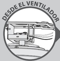
Usando un conector de alambre anaranjado de la bolsa de materiales ★, conecte los 3 alambres de puesta a tierra (verde, verde con banda amarilla, y cobre desnudo) del ventilador, el techo, y el soporte de suspensión.
