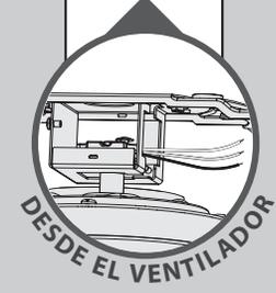
Gire los empalmes hacia arriba y presiónelos cuidadosamente hacia atrás a través del soporte de suspensión dentro de la caja de salida. Separe los alambres, con los alambres puestos a tierra a un lado de la caja de salida y los alambres no puestos a tierra al otro lado de la caja de salida.
