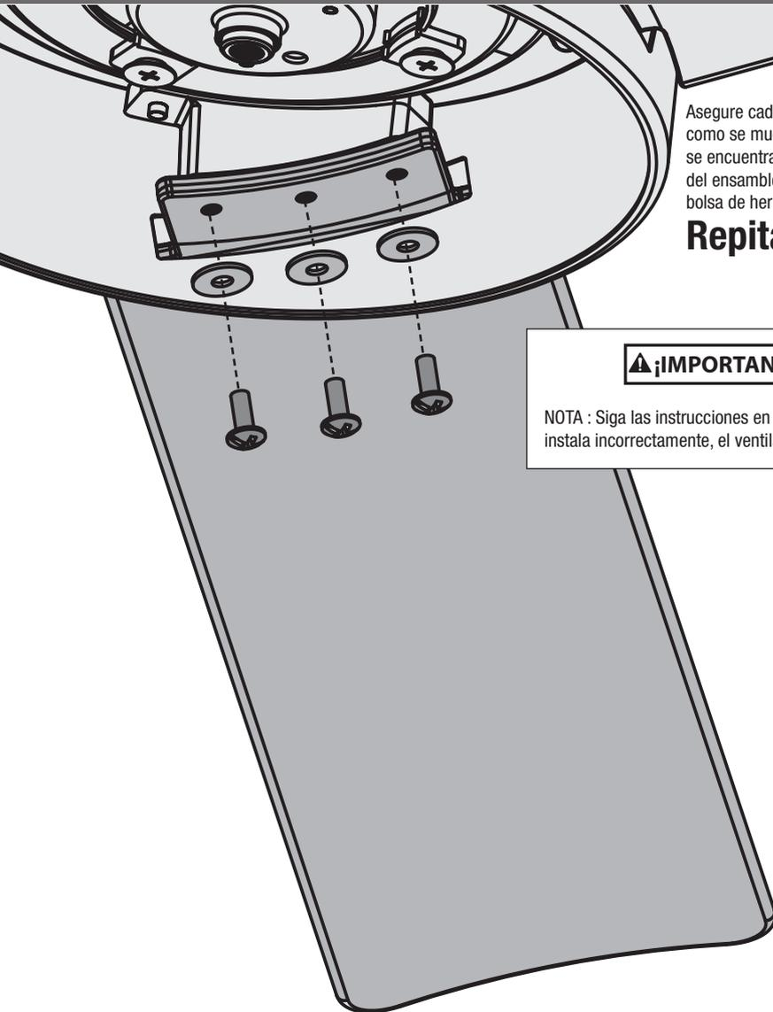
Asegure cada una de las aspas al soporte del aspa como se muestra usando las tuercas para el aspa que se encuentran en la ■ bolsa de herrajes, y los tornillos del ensamble del aspa, que se encuentran en la ▲ bolsa de herrajes.
