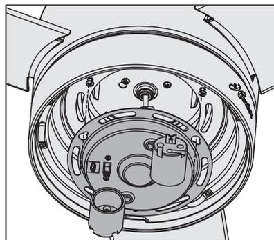
Alinee las ranuras de bocallave en el conjunto de luz con los tornillos de montaje. Asegúrese de que todos los alambres del ventilador y del conjunto de luz estén ajustados dentro del centro del conjunto de luz, y que no estén atascados entre la caja superior del interruptor y el conjunto de luz o colgando de los lados.
