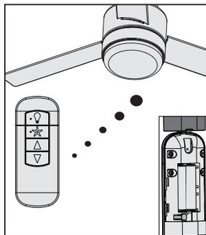
El transmisor del control remoto ya está sincronizado con el receptor y listo para usarse.
