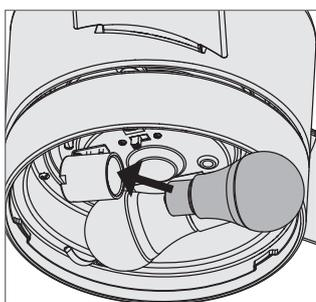
Instale las bombillas en cada uno de los portalámparas. Cuando sea necesario, reemplace las bombillas con unas del mismo tipo y voltaje.
