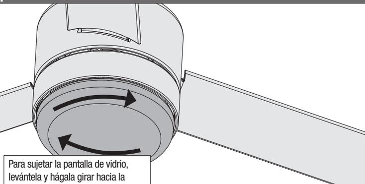
Para sujetar la pantalla de vidrio, levántela y hágala girar hacia la derecha un tercio de vuelta completa de la pantalla hasta que se detenga.
