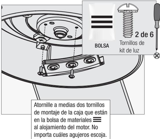
Atornille a medias dos tornillos de montaje de la caja que están en la bolsa de materiales
