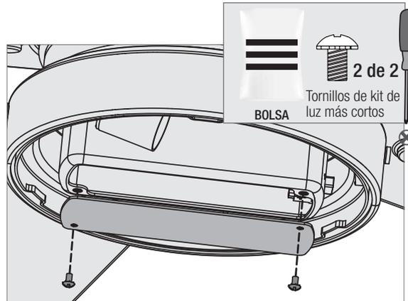
Empuje cuidadosamente todos los componentes de la caja del interruptor en la caja del interruptor, luego instale la placa de la caja del interruptor usando dos tornillos de ensamble del conjunto de lámparas que se encuentran en la
