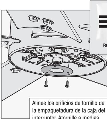
Alinee los orificios de tornillo de la empaquetadura de la caja del interruptor. Atornille a medias dos tornillos de montaje de la caja que están en la bolsa de materiales
