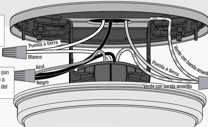
Conecte los tres cables de toma de tierra (verde, con raya verdes/amarilla, o de cobre desnudo) procedente del techo, de la varilla hueca y del soporte para montaje.
