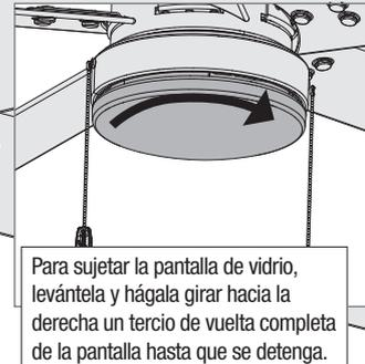
Para sujetar la pantalla de vidrio, levántela y hágala girar hacia la derecha un tercio de vuelta completa de la pantalla hasta que se detenga.
