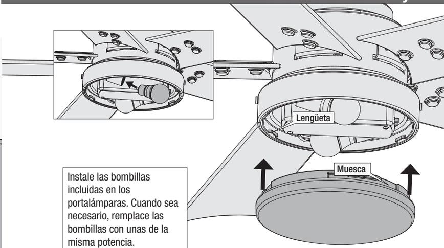
Instale las bombillas incluidas en los portalámparas. Cuando sea necesario, remplace las bombillas con unas de la misma potencia.
