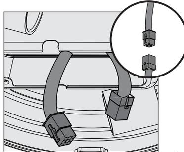
Pase el conector de 9 pines que viene de la parte inferior del alojamiento del motor a través de orificio central en el conjunto de lámparas. Conéctelo en el conector de enchufe que se encuentra en el área de la caja del interruptor del conjunto de lámparas. Asegúrese de alinear las marcas de color de los conectores.
