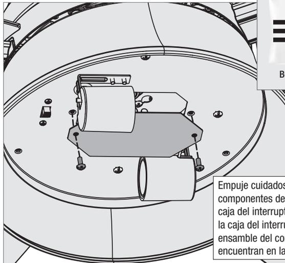
Empuje cuidadosamente todos los componentes de la caja del interruptor en la caja del interruptor, luego instale la placa de la caja del interruptor usando dos tornillos de ensamble del conjunto de lámparas que se encuentran en la
