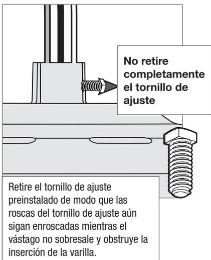
**No retire completamente el tornillo de ajuste**
