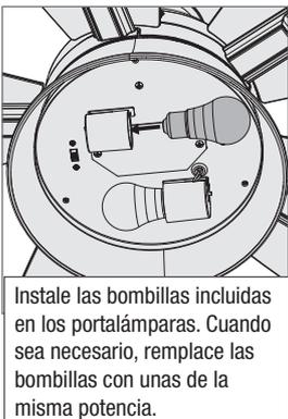
Instale las bombillas incluidas en los portalámparas. Cuando sea necesario, reemplace las bombillas con unas de la misma potencia.
