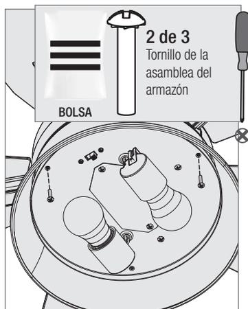
Instale parcialmente dos tornillos de ensamblaje de la jaula, encontrados en la bolsa de tornillería
