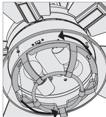
Levante el conjunto de jaula y alinee las ranuras de bocallave en la parte superior del conjunto de jaula con los tornillos del conjunto de jaula parcialmente instalados. Envuelva los orificios de bocallave alrededor de los tornillos y gire en sentido contrario de las manecillas.
