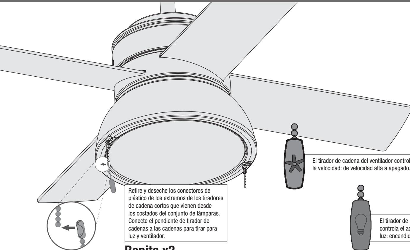
Retire y deseche los conectores de plástico de los extremos de los tiradores de cadena cortos que vienen desde los costados del conjunto de lámparas. Conecte el pendiente de tirador de cadenas a las cadenas para tirar para luz y ventilador.
