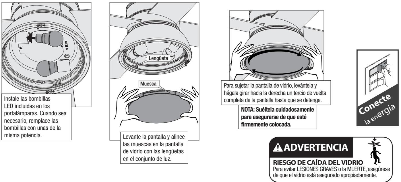
Instale las bombillas LED incluidas en los portalámparas. Cuando sea necesario, reemplace las bombillas con unas de la misma potencia.
