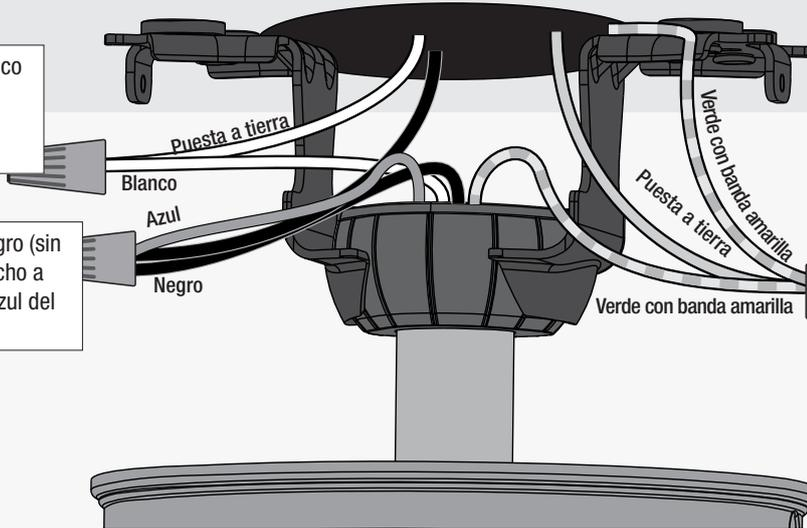
Conecte el cable negro (sin toma a tierra) del techo a los cables negro y azul del ventilador.
