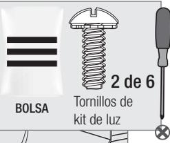
Atornille a medias dos tornillos de montaje de la caja que están en la bolsa de materiales
