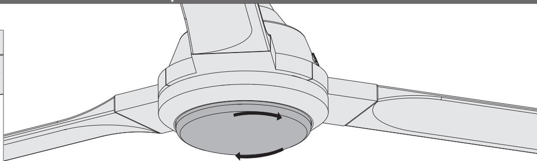
Para sujetar la pantalla de vidrio, levántela y hágala girar hacia la derecha un tercio de vuelta completa de la pantalla hasta que se detenga.
