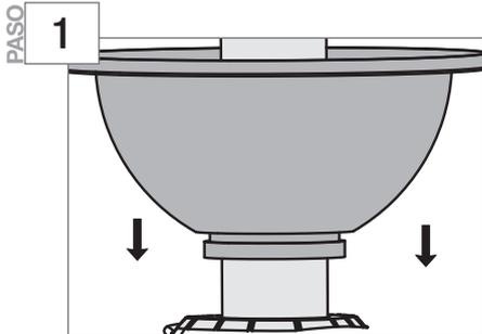
Deslice la cubierta del adaptador hacia el tubo de soporte hasta que descansa sobre la bola de suspensión.
