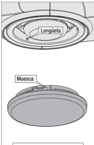
Levante la pantalla y alinee las muescas en la pantalla de vidrio con las lengüetas en el conjunto de luz.
