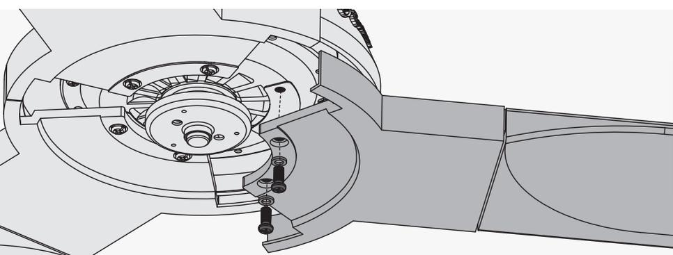
Fije cada aspa a un soporte de aspa usando las arandelas, que están en la bolsa ■, de aspa y los tornillos de montaje de aspa, que están en la bolsa ☒.
