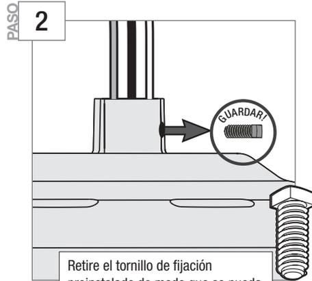
Retire el tornillo de fijación preinstalado de modo que se pueda insertar la varilla.
