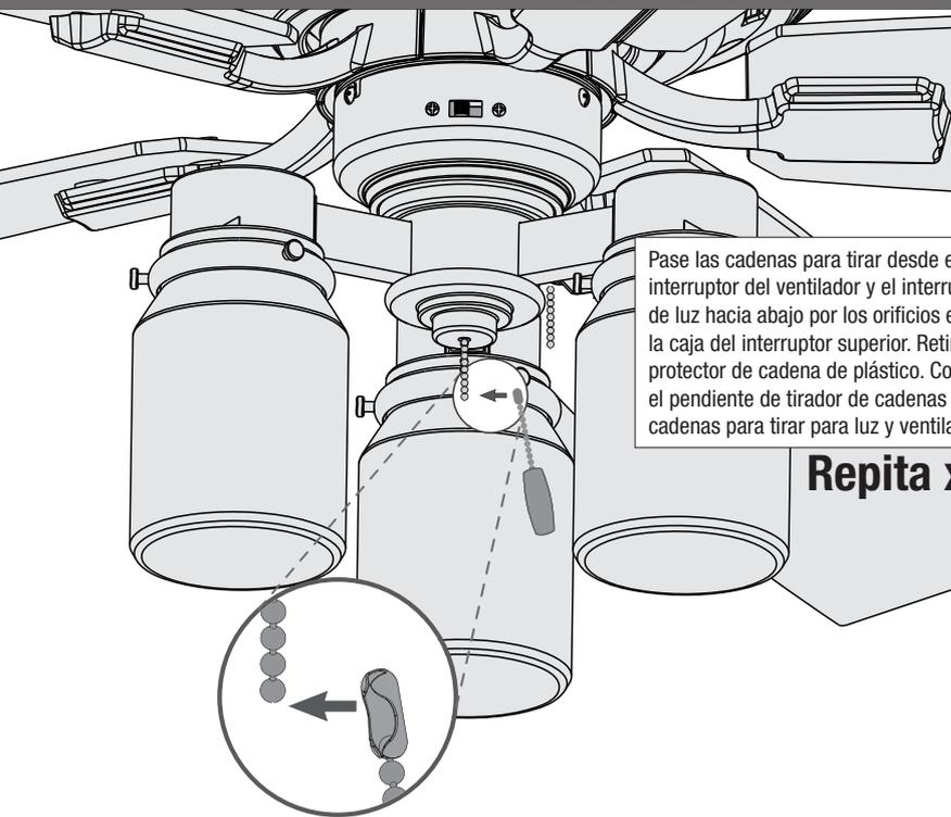
Pase las cadenas para tirar desde el interruptor del ventilador y el interruptor de luz hacia abajo por los orificios en la caja del interruptor superior. Retire el protector de cadena de plástico. Conecte el pendiente de tirador de cadenas a las cadenas para tirar para luz y ventilador.
