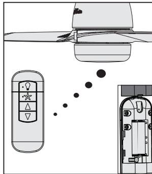
El transmisor del control remoto ya está sincronizado con el receptor y listo para usarse. **El modo de atenuación está desactivado por defecto.**
