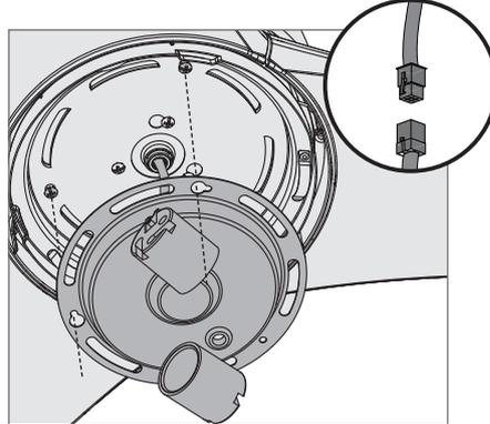
Conecte las clavijas de las cajas superior e inferior del interruptor. Asegúrese de alinear las marcas de color de los conectores. Alinee las ranuras de bocallave en el conjunto de luz con los tornillos de montaje. Asegúrese de que todos los alambres del ventilador y del conjunto de luz estén ajustados dentro del centro del conjunto de luz, y que no estén atascados entre la caja superior del interruptor y el conjunto de luz o colgando de los lados.
