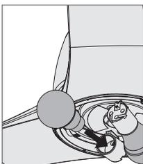
Instale las bombillas en cada uno de los portalámparas. Cuando sea necesario, reemplace las bombillas con unas del mismo tipo y voltaje.
