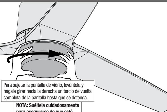
Para sujetar la pantalla de vidrio, levántela y hágala girar hacia la derecha un tercio de vuelta completa de la pantalla hasta que se detenga.
