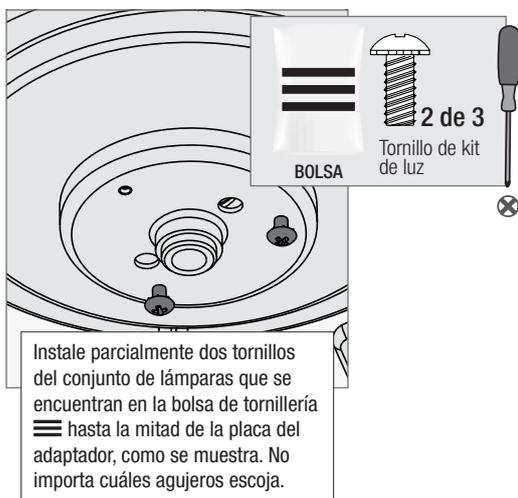
Instale parcialmente dos tornillos del conjunto de lámparas que se encuentran en la bolsa de tornillería ≡ hasta la mitad de la placa del adaptador, como se muestra. No importa cuáles agujeros escoja.
