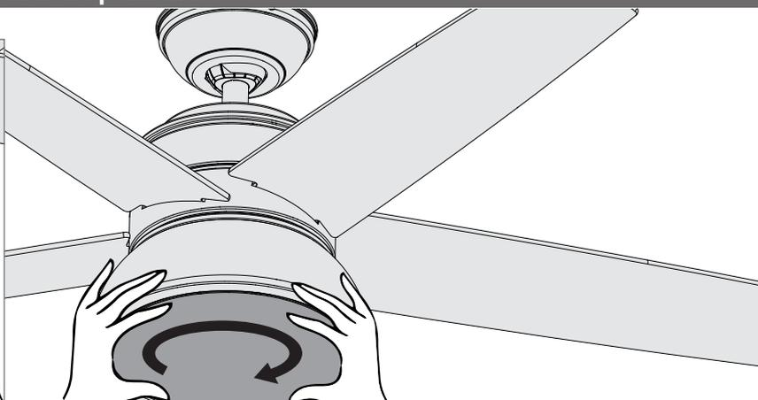
Para sujetar la pantalla de vidrio, levántela y hágala girar hacia la derecha un tercio de vuelta completa de la pantalla hasta que se detenga.
