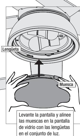
Levante la pantalla y alinee las muescas en la pantalla de vidrio con las lengüetas en el conjunto de luz.
