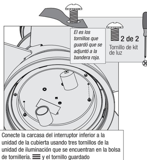
Conecte la carcasa del interruptor inferior a la unidad de la cubierta usando tres tornillos de la unidad de iluminación que se encuentran en la bolsa de tornillería ≡ y el tornillo guardado
