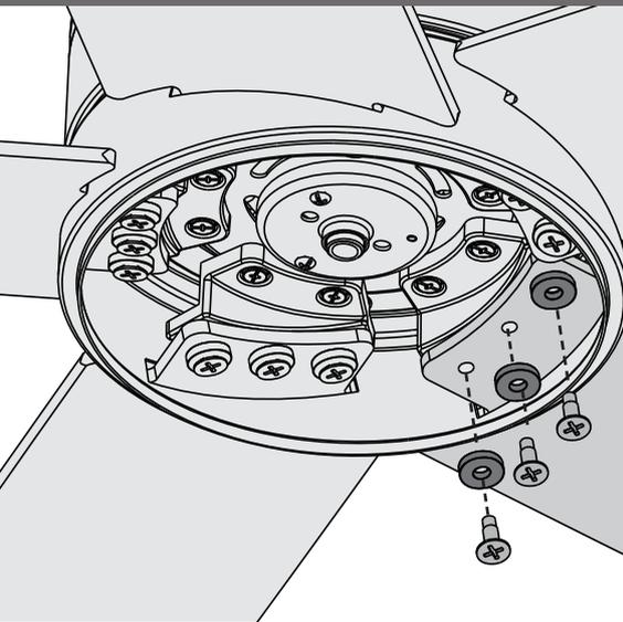
Asegure cada una de las aspas al soporte del asa como se muestra usando las tuercas para el asa que se encuentran en la bolsa de herrajes, y los tornillos del ensamble del asa, que se encuentran en la bolsa de herrajes.
