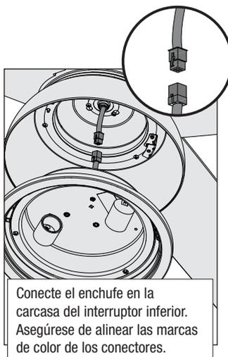
Conecte el enchufe en la carcasa del interruptor inferior. Asegúrese de alinear las marcas de color de los conectores.
