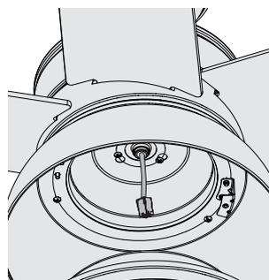
Haga pasar el enchufe de los cables a través del orificio central de la unidad de la tapa. Alinee las ranuras perforadas en la unidad de la tapa con los dos tornillos que acaba de instalar. Levante la unidad de la cubierta para que las ranuras perforadas se introduzcan en los tornillos y haga girar en dirección contraria a las agujas del reloj para fijar en posición la unidad de la cubierta.
