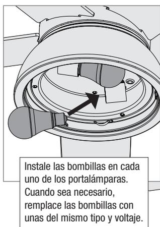
Instale las bombillas en cada uno de los portalámparas. Cuando sea necesario, reemplace las bombillas con unas del mismo tipo y voltaje.
