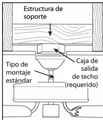
Emplee **un montaje estándar** o **un montaje de perfil** bajo para suspender el ventilador de un techo plano.
