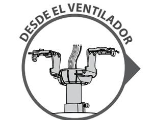
Usando un conector de alambre anaranjado de la bolsa de materiales ★, conecte los 3 alambres de puesta a tierra (verde, verde con banda amarilla, y cobre desnudo) del ventilador, la varilla y el soporte de suspensión.
